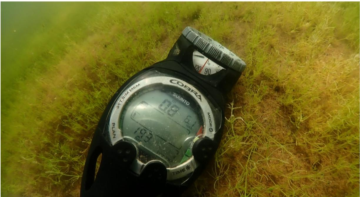
Abbildung 9: Anzeige des Tauchcomputers mit Kompass, hier im Flachwasser in 0,8 m Tiefe (Foto: van de Weyer).
